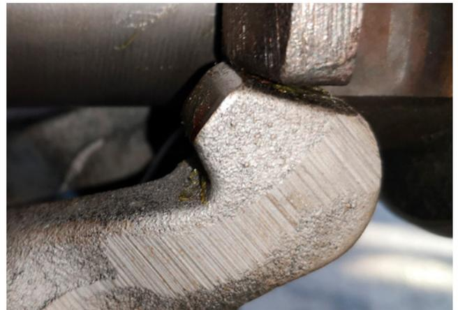
Image 1 : Fourchette de débrayage avec profil de came plat
