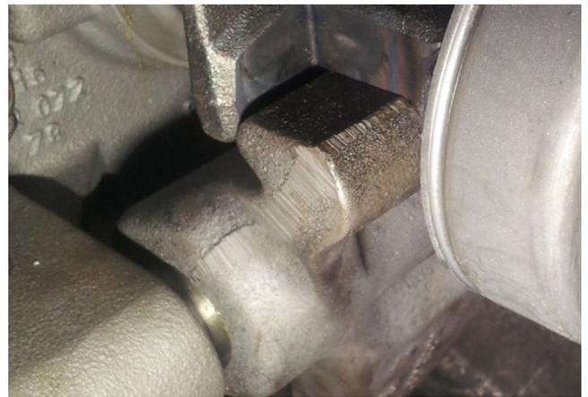
Image 2 : Fourchette de débrayage avec profil de came arrondi
