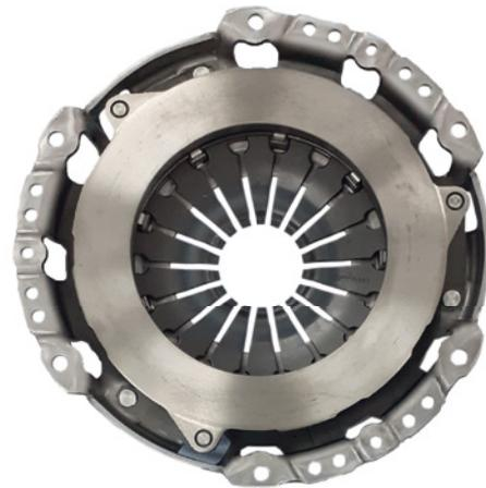
Figura 2: spingidisco 122 0505 10 con un diametro ridotto della superficie di attrito di 200 mm
