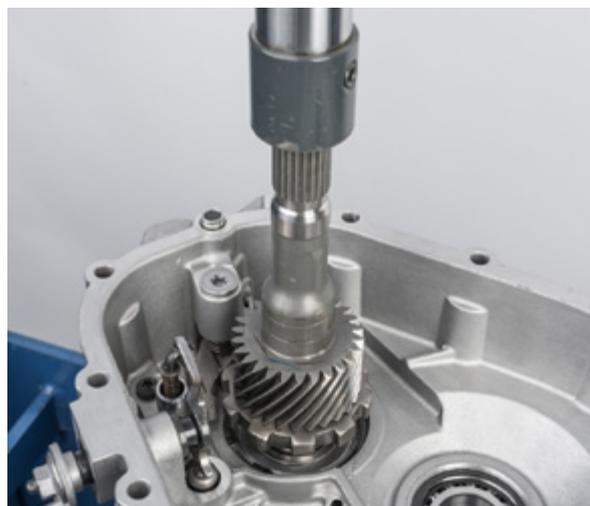
Inserir com pressão o veio de saída no cárter da caixa de velocidades.
