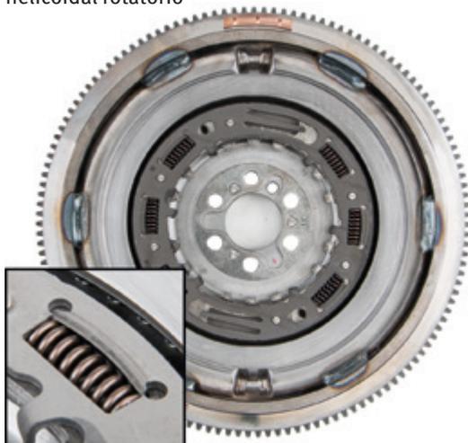
Versión 4: Anillo de tensado sin aleta para un muelle helicoidal rotatorio
