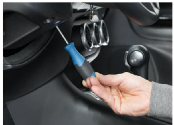
El dispositivo de bloqueo de la llave de contacto se puede anular con un destornillador
