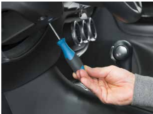
Pour déverrouiller la serrure de la clé de contact, utiliser un tournevis.
