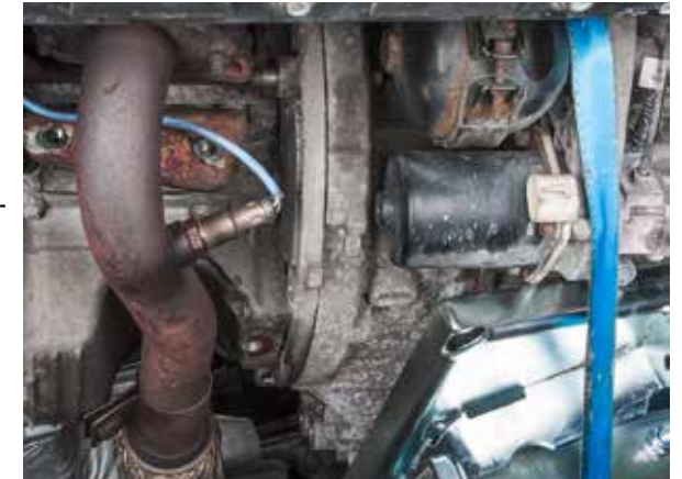
Rapprocher autant que possible la boîte de vitesses du moteur.
