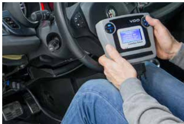
Basisinstelling met een geschikt diagnoseapparaat
