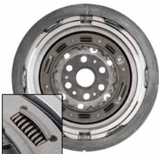
Uitvoering 1: spanring met veerkamervleugels
