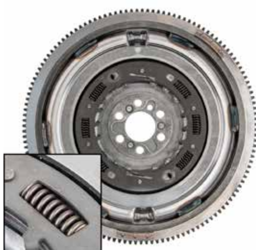
Uitvoering 4: spanring zonder veerkamervleugels
