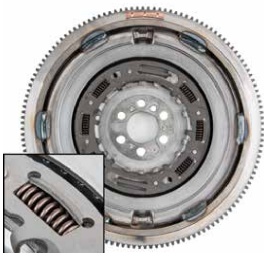
Uitvoering 2: spanring met veerkamervleugels
