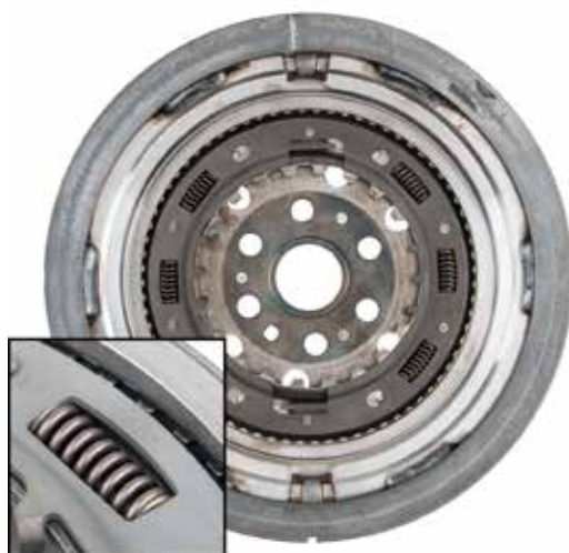
Uitvoering 3: spanring zonder veerkamervleugels
