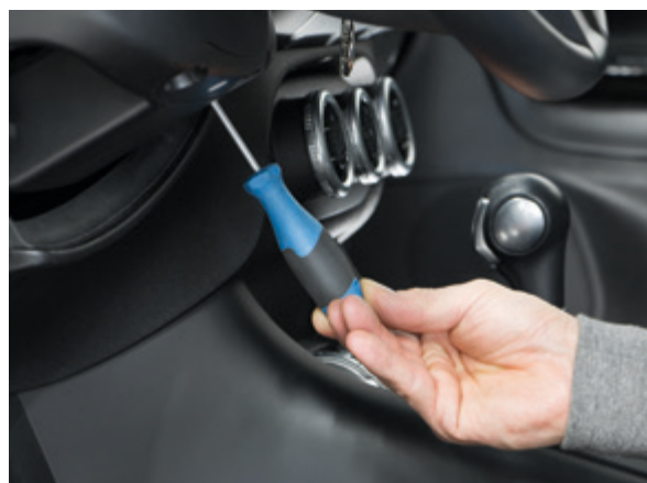
O dispositivo de bloqueio para a chave de ignição pode ser anulado ao utilizar uma chave de fendas
