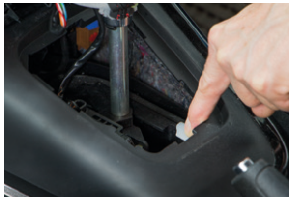
A alavanca de velocidades pode ser desbloqueada através de um botão de pressão
