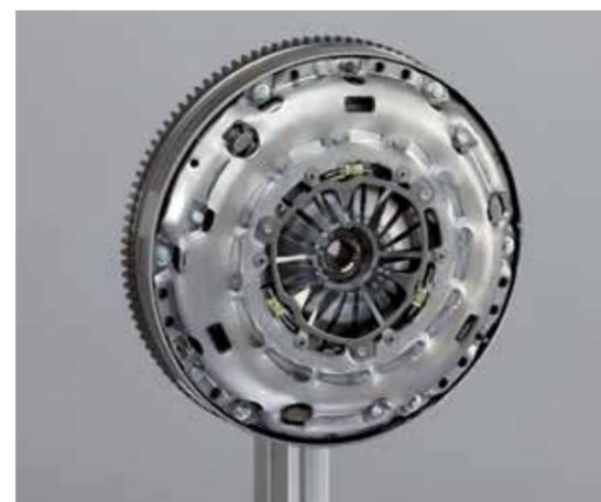
Se si deve smontare e poi riutilizzare la frizione SAC in caso di riparazione, è necessario eseguire lo smontaggio con l'attrezzo specifico. Solo eseguendo lo smontaggio in modo corretto è infatti possibile garantire il perfetto funzionamento dopo il rimontaggio.
