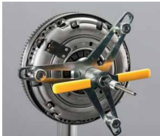
**Esempio di montaggio: frizione autoregolante a controllo di corsa**
