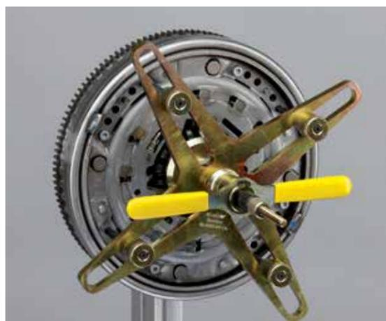
**Esempio di montaggio: frizione autoregolante a controllo di forza**
