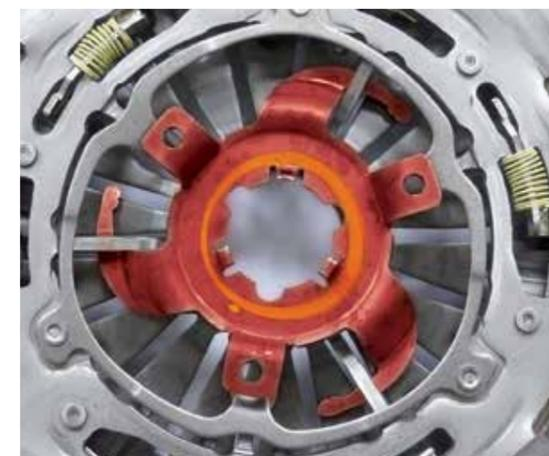
I complessivi spingidisco per i modelli di queste marche possono essere forniti con un elemento di blocco. Il montaggio del disco frizione avviene con un perno di centraggio universale.
