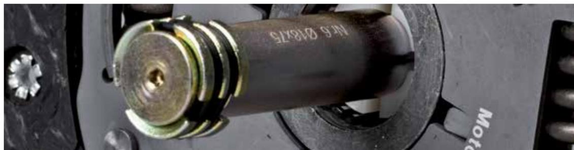
Il corretto montaggio del perno di centraggio dipende dal diametro del cuscinetto di guida se presente nell'albero motore o dal foro praticato nell'albero motore stesso e anche dalla distanza tra il mozzo scanalato del disco della frizione e il cuscinetto di guida o il foro praticato nell'albero motore.
