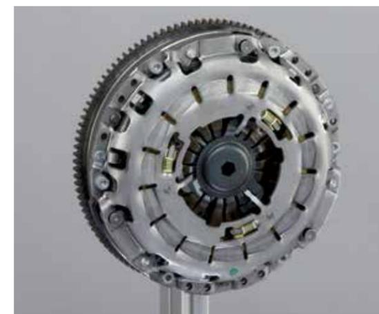
Il complessivo spingidisco di alcuni modelli BMW è equipaggiato con un dispositivo di blocco che rende impossibile l'utilizzo del perno di centraggio del disco frizione. Per questo motivo è necessario utilizzare un perno di centraggio o una boccola di centraggio specifici.
