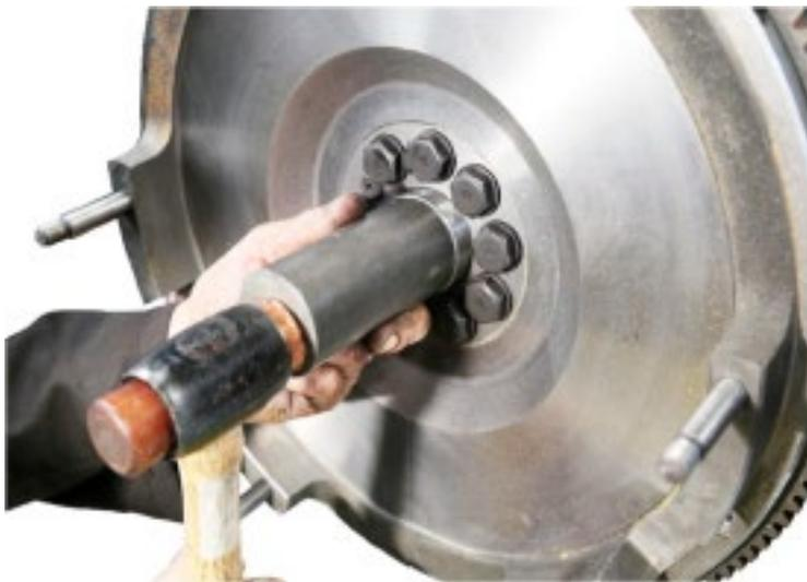
Шаг 6 – проверьте правильность установки ведомого диска сцепления. Маркировка «FW / Side» обозначает «сторона маховика».
