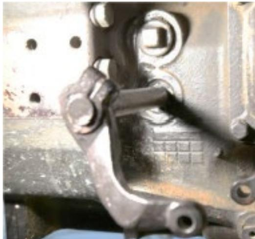
Шаг 12 – замените изношенный вал привода вилки сцепления и опорные втулки в корпусе трансмиссии.
