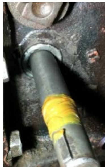
Шаг 17 – очистите шлицы первичных валов, нанесите небольшое количество смазки на направляющую втулку, установите выжимной подшипник, проверьте свободный ход.
