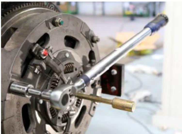
Шаг 9 – удалите 3 транспортировочные опоры (отделяются самостоятельно при полной протяжке гаек крепления сцепления).
