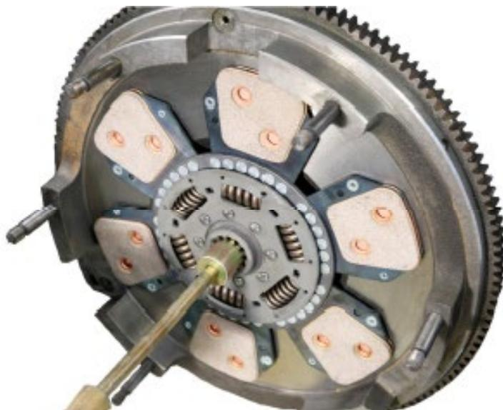
Шаг 8 – зафиксируйте корзину сцепления на маховике, используя схему параллельной протяжки «звезда». Законтрите гайки моментом затяжки от 70 до 90 Нм.
