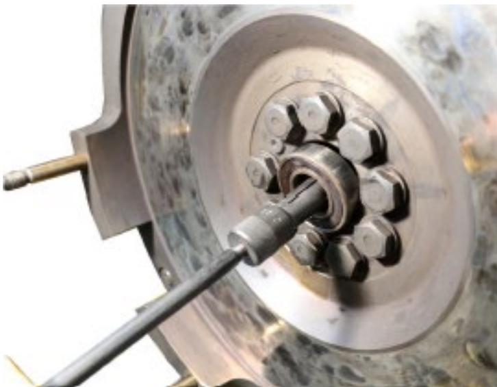
Шаг 4 – поверхность трения маховика должна быть плоской без следов перегрева, микротрещин, канавок и т.п. Чтобы устранить заполированность поверхности трения, её необходимо зачистить наждачной бумагой средней зернистости.
