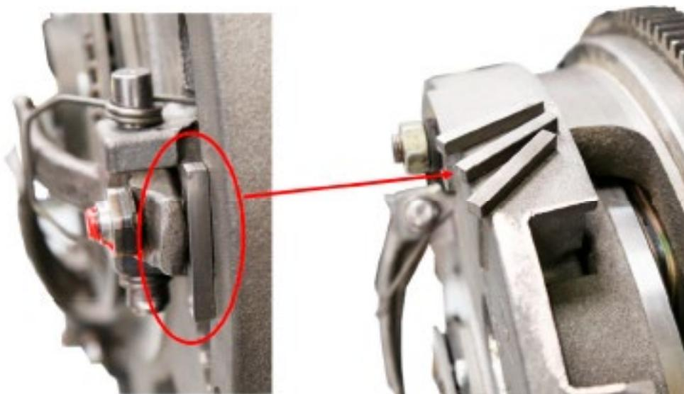
Шаг 10 – снимите выжимной подшипник. Очистите поверхность корпуса трансмиссии от масла и грязи. Рекомендуется замена сальника первичного вала КПП.
