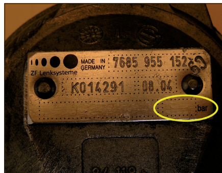
Bomba de servodirección ZF sin válvula de limitación de presión
