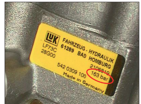
Bomba de servodirección LuK con válvula de limitación de presión
