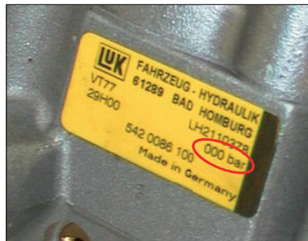
Bomba de servodirección LuK sin válvula de limitación de presión
