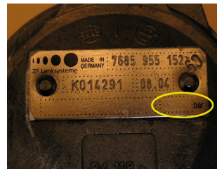
Ohjaustehostimen ZF-pumppu ilman paineenrajoitusventtiiliä
