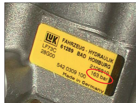
Pompa del servosterzo LuK con valvola di pressione
