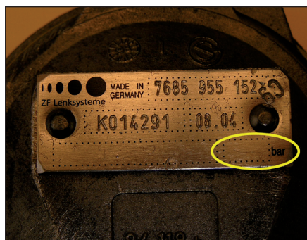
Pompa del servosterzo ZF senza valvola di pressione
