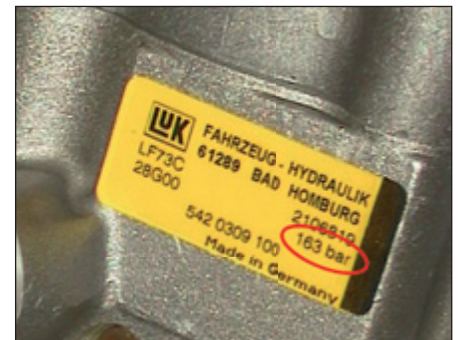
Bomba de direcção assistida LuK com válvula de limite de pressão
