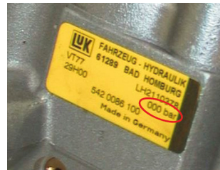
Зображення 1: Насос гідропідсилювача керма LuK без клапана обмеження тиску
