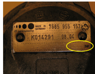
Зображення 3: Насос гідропідсилювача керма ZF без клапана обмеження тиску
