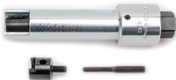
Fig. 1: A ferramenta especial Klann KL-1600-10 facilita a desmontagem sem problemas
