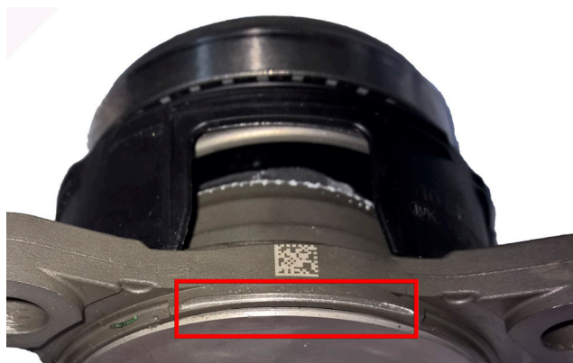
Рисунок 2: Поврежденный корпус подшипника со снятым уплотнением
