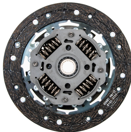
Εικόνα 2: Δίσκος συμπλέκτη LuK με αποσβεστήρα τεχνολογίας φυγοκεντρικού εκκρεμούς (πλευρά κιβωτίου)
