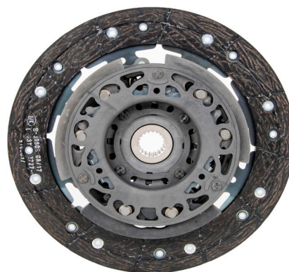
Slika 1: LuK lamela spojke s centrifugalnim njihalima (strana motora)
