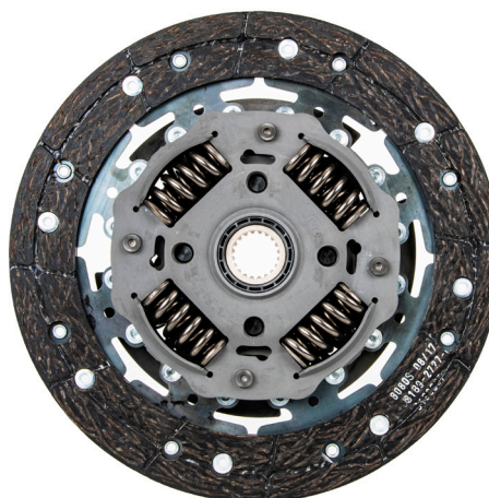
2. ábra: LuK kuplungtárcsa centrifugális inga csillapítóval (sebességváltó felőli oldal)
