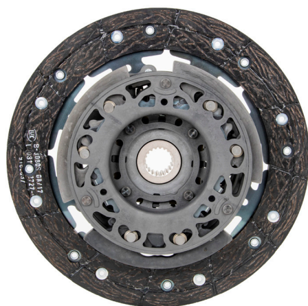
1. ábra: LuK kuplungtárcsa centrifugális inga csillapítóval (lendkerék felőli oldal)
