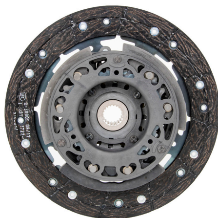
Fig. 1: Discul de ambreiaj LuK cu amortizoare tip pendul centrifugal (partea dinspre volant)
