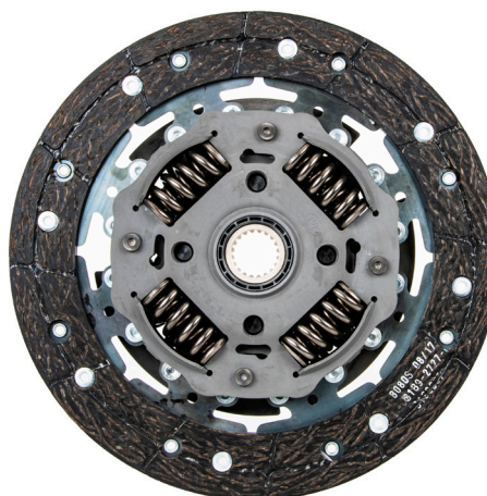
Fig. 2: Discul de ambreiaj LuK cu amortizoare tip pendul centrifugal (partea dinspre transmisie)
