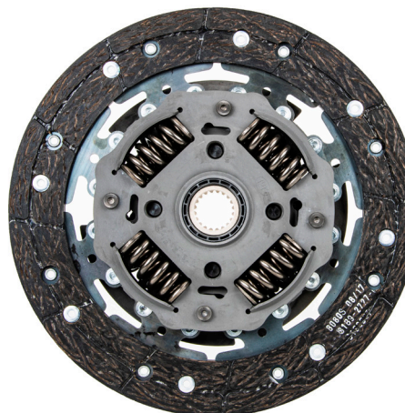
Рисунок 2: Диск сцепления LuK с центробежными маятниками (со стороны привода)
