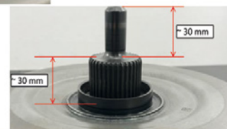
Figura 3: Dimensioni modificate degli ingranaggi e del perno di guida
