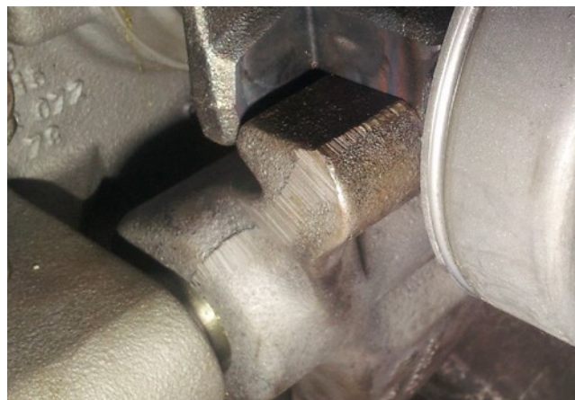
Rysunek 2: Widetki z zaokrąglonym profilem krzywki
