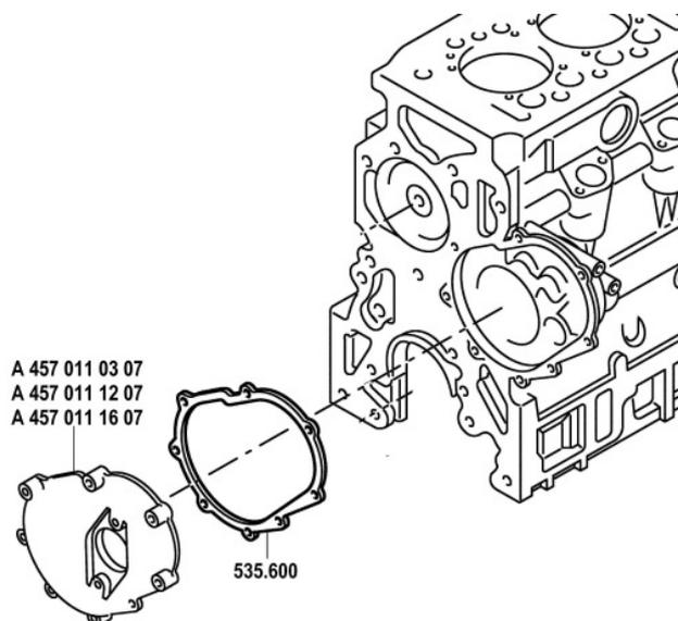
Para una mejor unión de la tapa de piñon del árbol de levas situada en el bloque motor, se ha desarrollado una nueva junta Metaloseal®. Esta sustituye al compuesto de sellado que se usaba hasta ahora.
