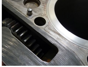
Düz dişli çarklı motor bloğu conta yüzeyleri
