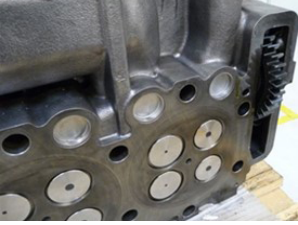
Düz dişli çarklı silindir başlığı conta yüzeyi
