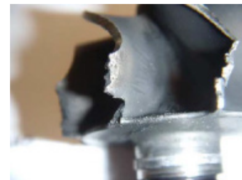
Turbina do escape danificada
