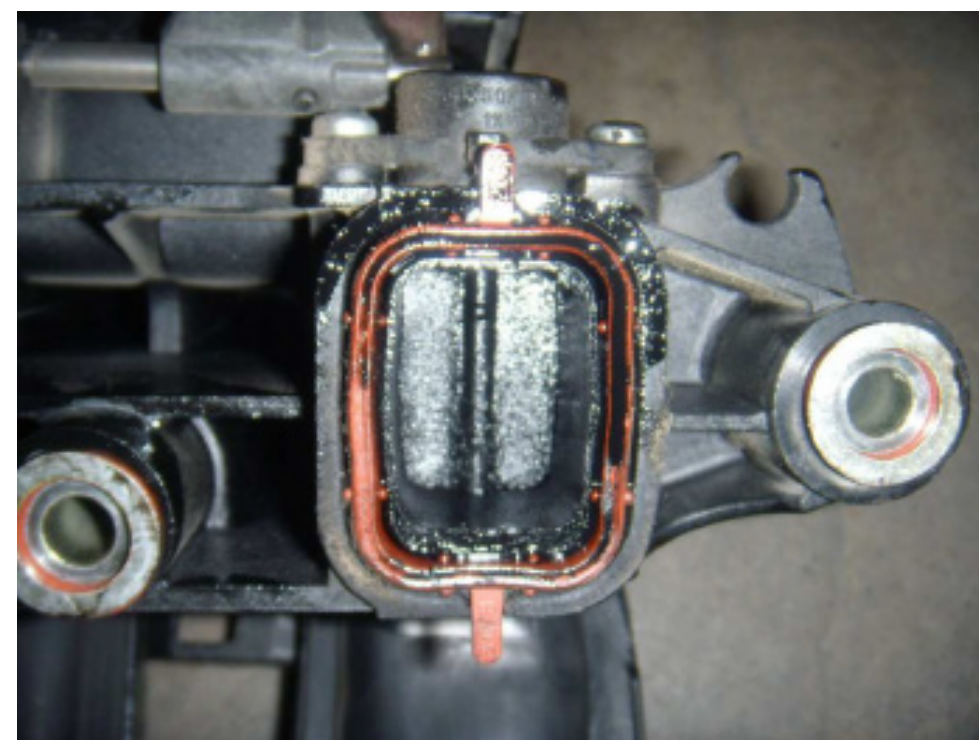
Luftindtagsmanifold af plast med ekstra hvirvelklap
