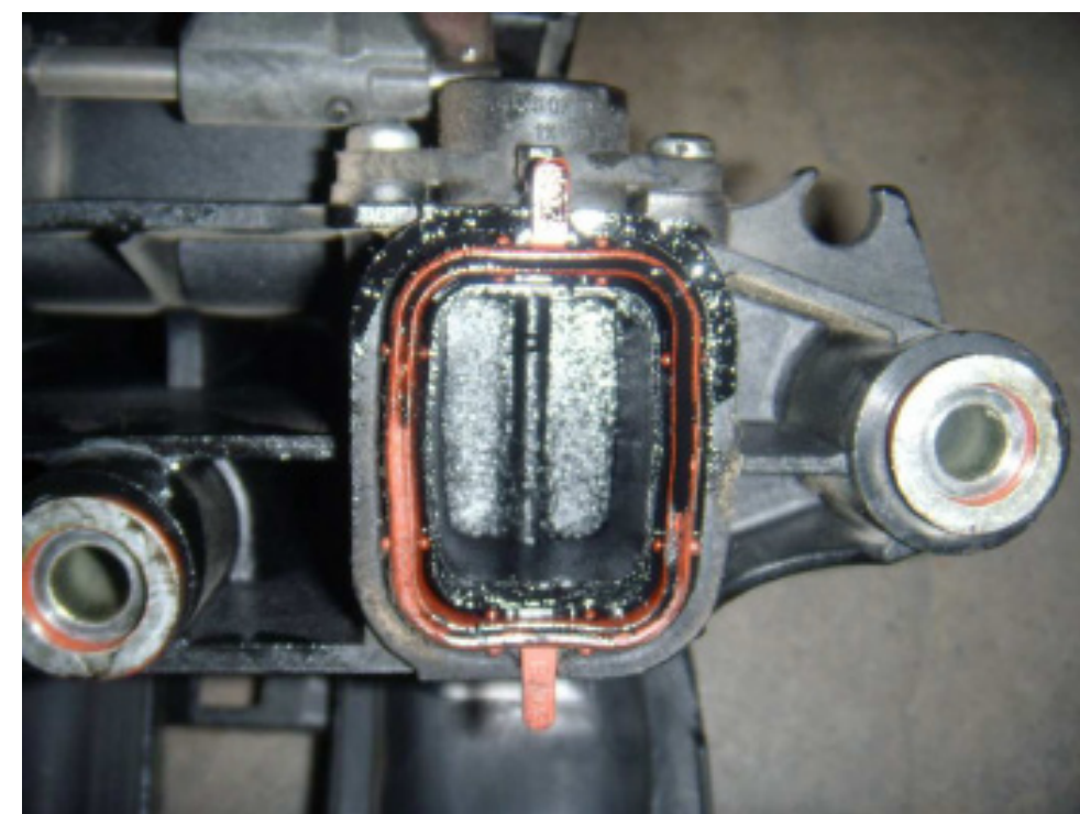
Kolektor dolotowy powietrza z tworzywa sztucznego z dodatkową kłapą zawirowującą
