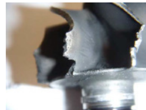
Poškodovana izpušna turbina
