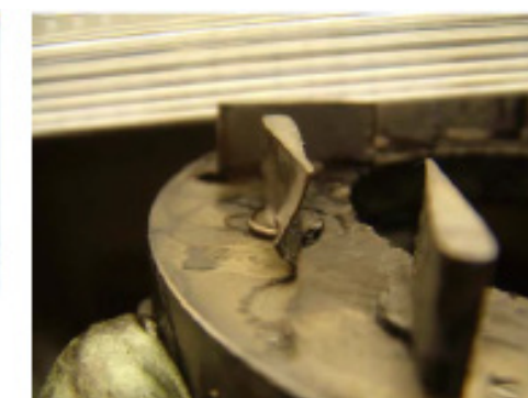
Aubes de tuyère endommagées
