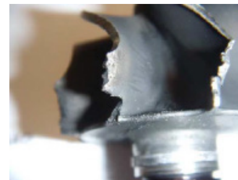
Poškozená výfuková turbína
