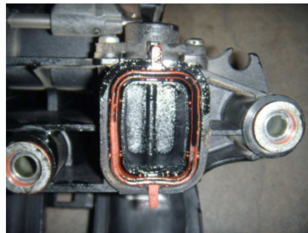
Plastové sací potrubí s další hvězdicovitou klapkou.
