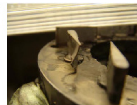
Poškozené trysky lopatky
