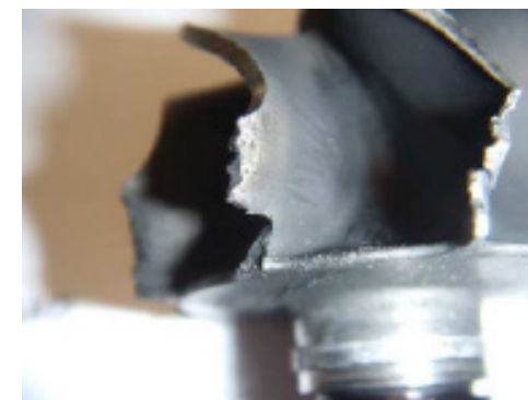
Turbină de evacuare deteriorată
