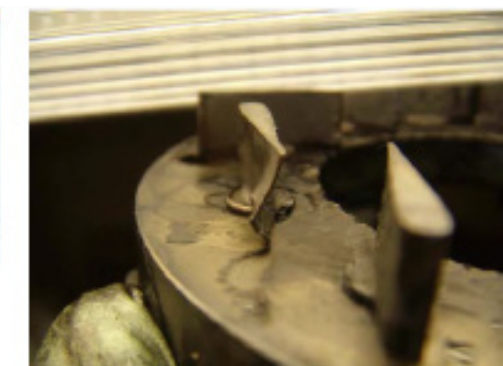
Beschädigte Düsen der Laufschaufeln
