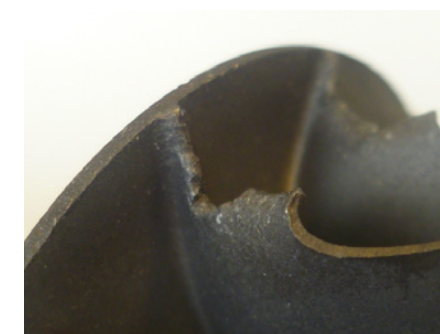
Turbină de evacuare deteriorată
