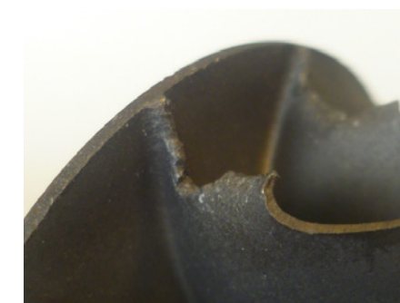
Poškodovana izpušna turbina
