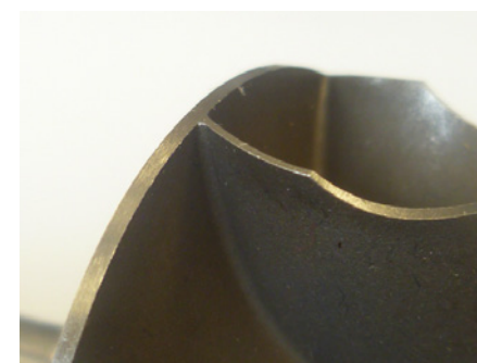
Turbină de evacuare nouă, nedeteriorată
