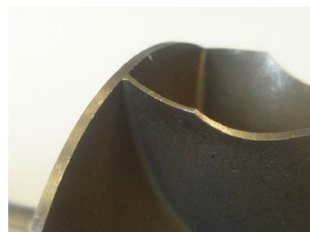
Ny, ubeskadiget udstødningsturbine
