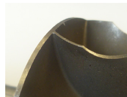
Nova, nepoškodovana izpušna turbina
