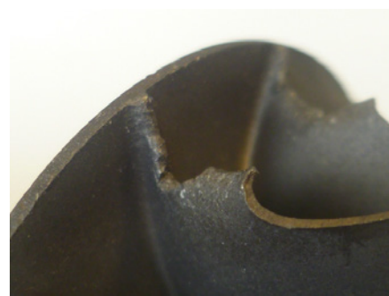
Turbina escape dañada
