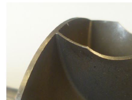
Neue Turbine, ohne Beschädigungen
