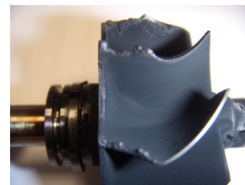
Turbine d'échappement endommagée
