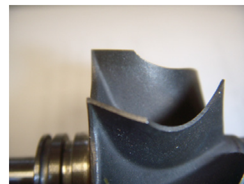
Nieuszkodzona turbina wydechowa
