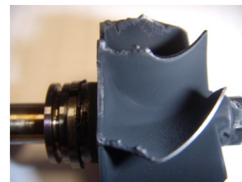
Uszkodzona turbina wydechowa
