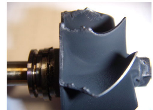
Turbina scarico danneggiata
