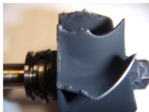
Poškozená výfuková turbína
