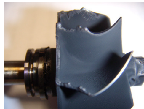
Turbina escape dañada
