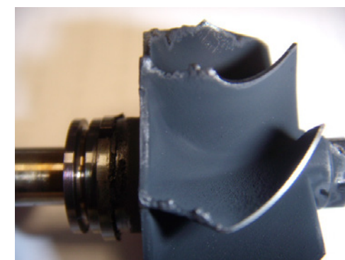
Poškodovana izpušna turbina
