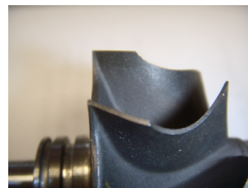
Turbine d'échappement en bon état
