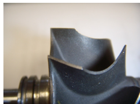
Turbina escape sem danificação
