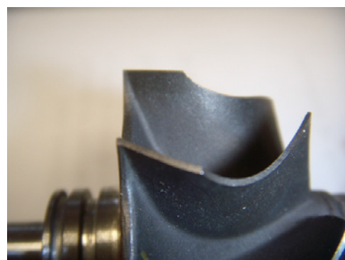
Nepoškozená výfuková turbína
