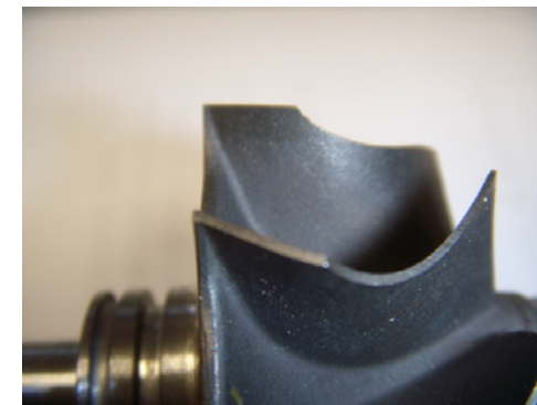
Turbina dello scarico senza danni
