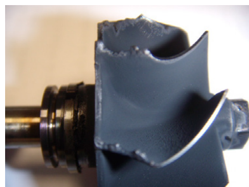
Turbina escape danificada
