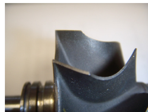
Nepoškodovana izpušna turbina
