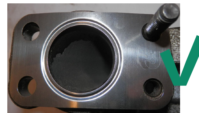
Mise en place correcte
