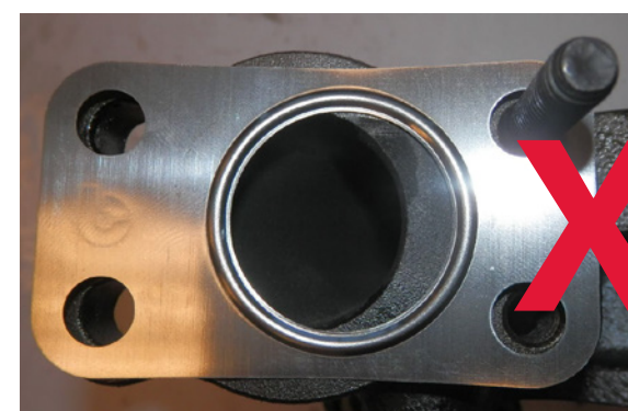
Mise en place incorrecte
