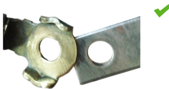
2. ábra: Testcsatlakozás tisztítás után: jó érintkezés
