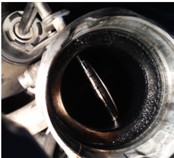
4. ábra: A kipufogógáz-visszavezető szelep (AGR-szelep) csappantyúja kókszol
