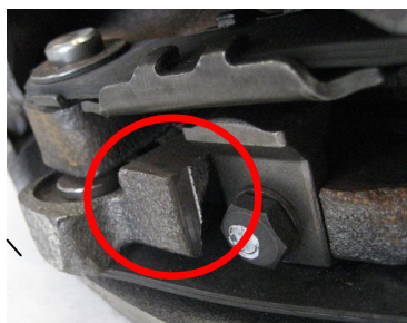
Obr.č. 2 + 3: Praskliny oka vloženého kotouče
