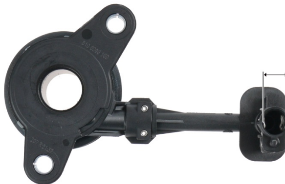
Sl. 4: CSC 3182 600 140 → 3182 654 204 prečnik hidrauličkog priključka 12,2 mm
