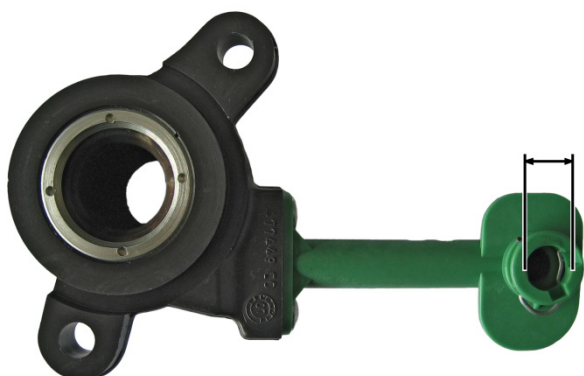
Sl. 1: CSC 3182 600 121 → 3182 654 165 Premer hidravličnega priključka 11,7 mm
