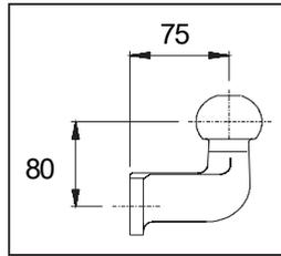
**NL** Bij gebruik van deze trekhaak met een 2-gats kogel dient men een UNECE R55-goedgekeurde kogel te monteren welke voldoet aan een lengte van 75mm, een hoogte van 80mm en aan de minimale D-waarde vlg. pagina 2.
