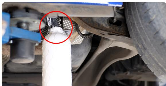
Positionner le bidon vide et le petit tube (bidon vide et accessoires fournis dans le kit BOSAL)
