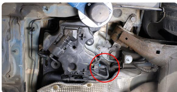
Retirer le couvercle de protection pour accéder au réservoir d'additif.
