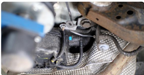
Raccorder le tuyau de remplissage.
