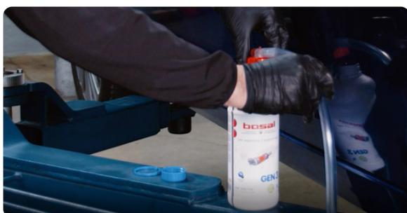
Raccorder le tube de trop-plein au bidon d'additif. **Lors du remplissage, placer le bidon Bosal GEN plus haut que le réservoir.** Utiliser une poignée ou le cadre de la porte. (un filet et des crochets sont fournis dans le kit BOSAL)
