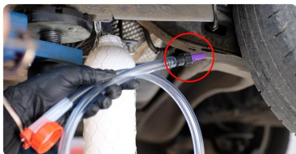
Raccorder avec le tube de trop-plein (fourni dans le kit BOSAL)
