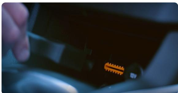
Reconnecter l'outil de diagnostic à la prise OBD pour réinitialiser les réglages de l'additif.
