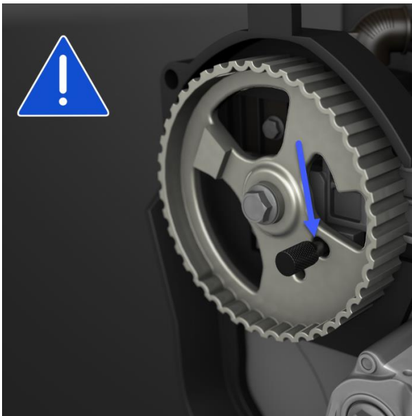
Árbol de levas y piñón del árbol de levas bloqueados: Agujero en la posición de las 4 en punto.
