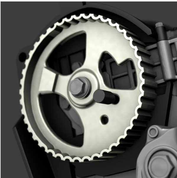
Correa dentada (PMS). Orificio en posición 4 en punto.
