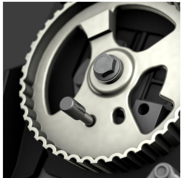
Ajuste de la bomba de alta. Orificio en posición 6 en punto.
