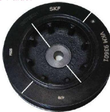
**A SKF e o fabricante de equipamento original recomendam vivamente a substituição do polia da cambota e do sistema de distribuição no mesmo momento, sem aguardar pela falha do polia da cambota!**
