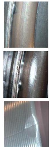
Lagerschäden auf Grund von Einbaufehlern
