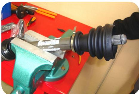
1. Coloque en primer lugar la abrazadera corta del guardapolvos en el eje.
