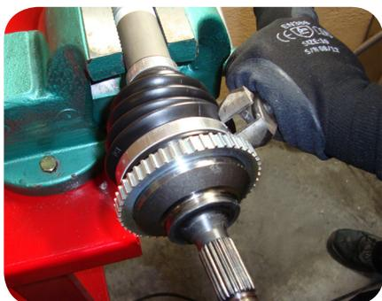
2. Coloque la transmisión en un torno (con mordazas protectoras o de aluminio). Extraiga el clip interior y el clip exterior. Corte el guardapolvos y extráigalo.
