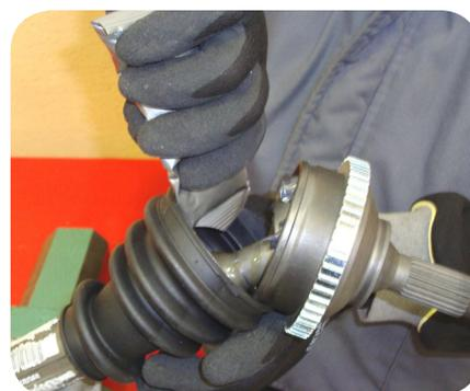
5. Coloque las abrazaderas corta y larga en el guardapolvos de la junta homocinética y apriételas con una herramienta apropiada.
