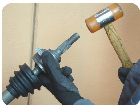
3. Accostate il nuovo giunto all'albero. Fate scorrere il giunto omocinetico sull'albero con dei leggeri colpi di martello fino a quando il circlip si blocca nella sua sede nel nucleo del giunto. Rimuovete la fascetta a vite.
