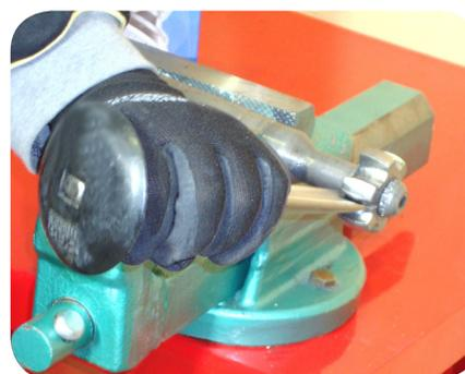
6. Aprite e rimuovete il circlip con le apposite pinze.
