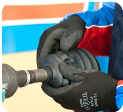
1. Coloque la abrazadera corta del guardapolvos en el eje.
