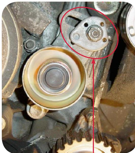
La tensione viene effettuata manualmente mentre si gira la piccola piastra metallica. Con questo nuovo design, il pistone non è più necessario.
