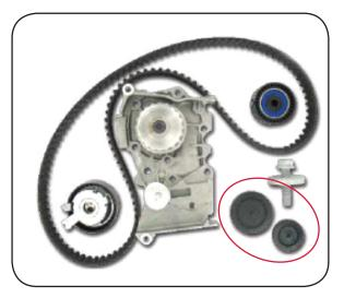
Les 2 bouchons d'étanchéité sont abimés ou détruits lors du remplacement de la distribution sur les moteurs Renault ci-dessus.
