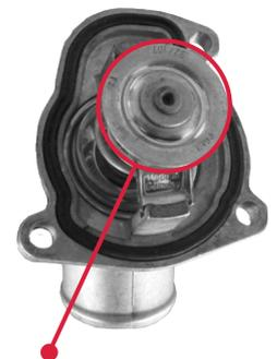
Versione del termostato non in linea con le specifiche delle case auto. (Diametro: >23 mm)
