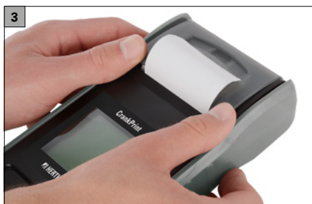
Fig. 3 Fermeture du couvercle du compartiment à papier
