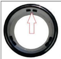
Der Adapterring verfügt auf der Innenseite über drei Verriegelungsnasen, von denen eine mit einer Positionsnut ausgestattet ist. Der Stecker besitzt eine entsprechende Verriegelungsführung. Setzen Sie den Adapterring so auf den Stecker, dass die Positionsnut des Rings mit der Verriegelungsführung des Steckers übereinstimmt. Drehen Sie den Ring anschließend um 90° im Uhrzeigersinn.
