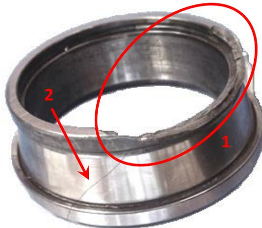
Teile des Bunds gelangen dann auf die Lagerlaufbahnen, verursachen in kurzer Zeit Laufgeräusche und zerstören schließlich das Lager.
