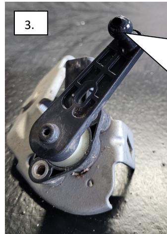
**Achtung: Bruch- und Beschädigungsgefahr des Drehwinkelsensors und der Befestigungspunkte!**
