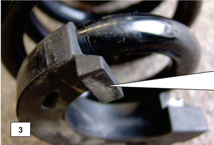
Beim Einsetzen der Feder ist zu beachten, dass der Endanschlag des Federteller bündig mit der OE-Federaufnahme abschließt.
