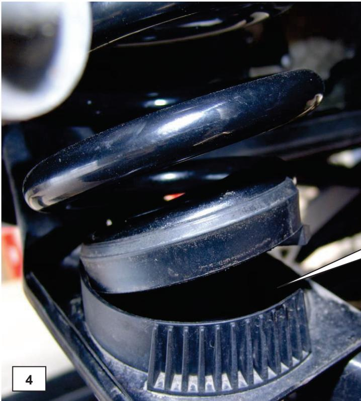
Bei dem Verbau der Feder muss der Sitz nach Herstellervorgaben überprüft werden.
