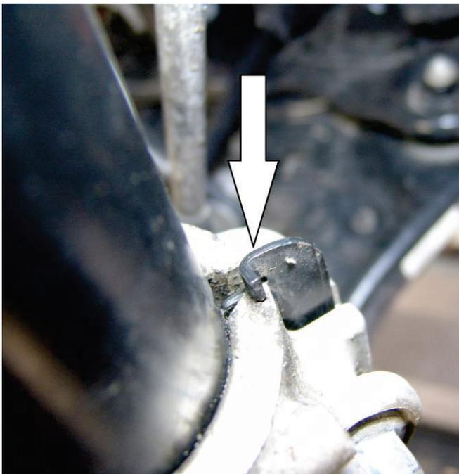
Beim Einsetzen des Dämpfers ist zu beachten, dass die Endanschläge des Dämpfers sich im intakten Zustand befinden und nach Werkstatthandbuch im Achsschenkel positioniert sind.
