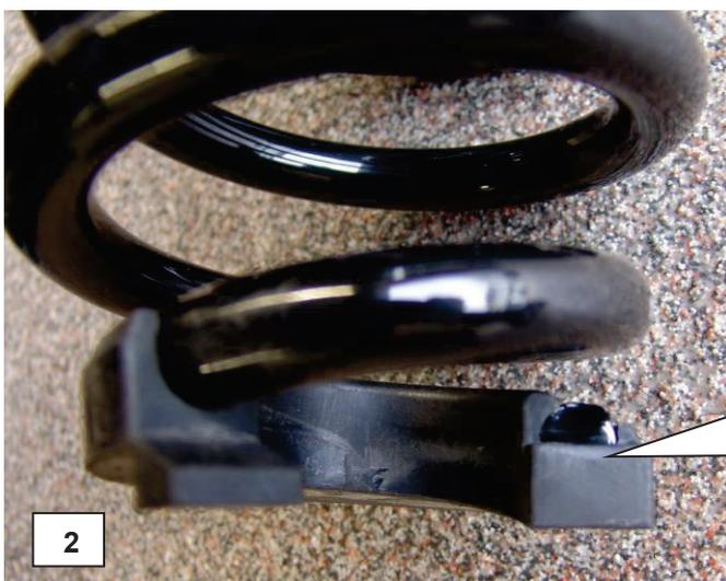
Der Federteller AZ45-85-052-01-02 wird auf die Feder gesteckt und bis an den Endanschlag des Federteller gedreht.
