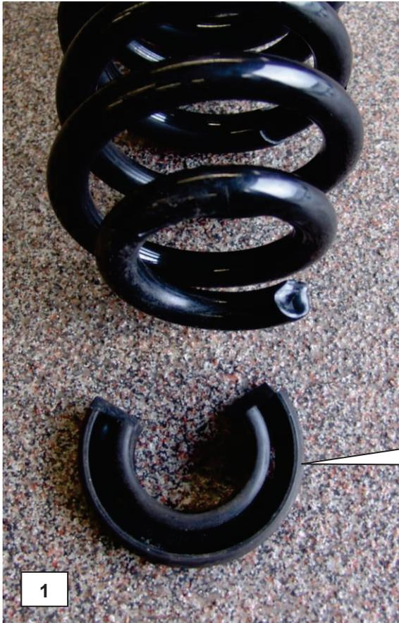
Der mitgelieferte Federteller AZ45-85-052-01-02 wird an der Hinterachse unten angebracht.
