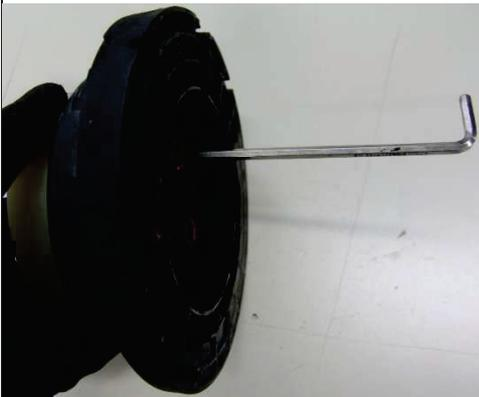
*Verschrauben der serienmäßigen Endanschlüge mit den neuen Endanschlagadaptern mittels mitgelieferter Innensechskantschrauben (M6x16mm) an 3 Punkten.*
