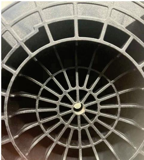
Anschließend den Endanschlag mit einem Bohrungsdurchmesser von 6,5mm durchbohren.
