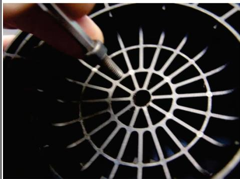
*Verschrauben der serienmäßigen Endanschlüge mit den neuen Endanschlagadaptern mittels mitgelieferter Innensechskantschraube (M6x16mm) an einem Punkt (mittige Bohrung).*
